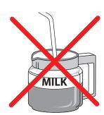
LEAVE THE STEAM NOZZLE IMMERGED IN THE MILK ONLY FOR THE TIME REQUIRED FOR HEATING. DO NOT OPEN THE STEAM TAP WITH THE STEAM NOZZLE IMMERGED IN MILK WHILE THE MACHINE IS OFF.
