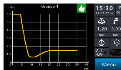
Diagramma del flusso nel tempo (ml/sec) del caffè erogato per singolo gruppo.
